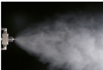
Feinstzerstäubung mittels Druckluft ultra-fine atomisation by compressed air
