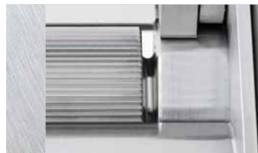
Construction avec rainure hygiénique sur rouleau entraîneur racleur
