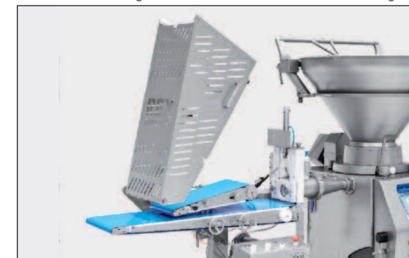
Formage de steaks hachés à l'aide de la guillotine et de la bande de formage
