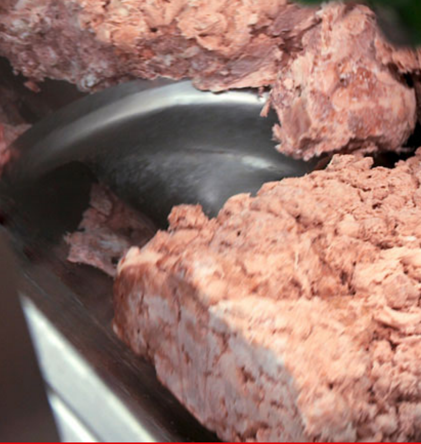
Zubringerschnecke aus Spezialguss mit Schälkante
