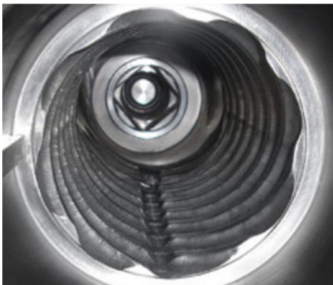
Massives, rostfreies Schneckengehäuse, robuste Lagerung des Antriebs
