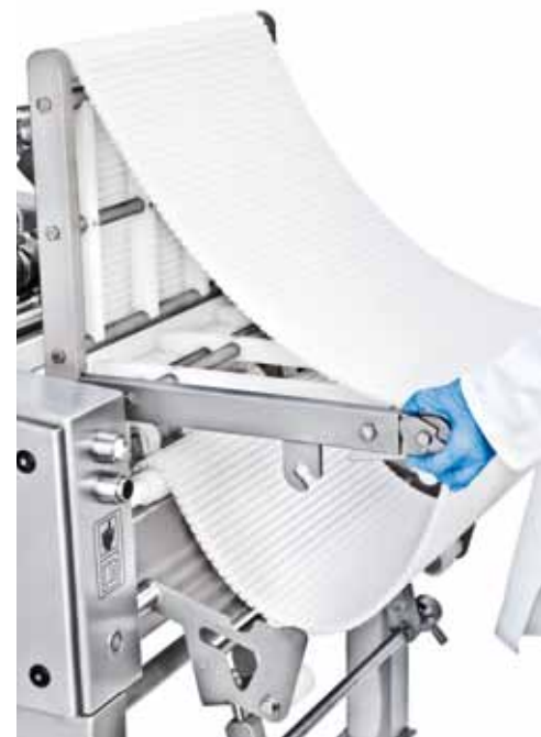
Einfacher Umgang mit Zu- und Abführband für Reinigungszwecke
