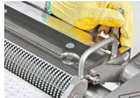
Messer-Schnellspanverschluss erleichtert den Messerwechsel
