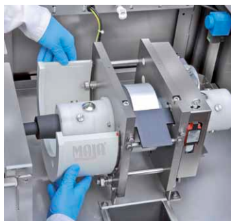
Sortie du bac à eau pour le nettoyage manuel
