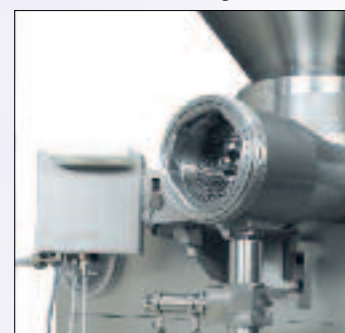
Trémie divisible de 250 et 350 litres
