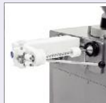
Main automatique fixe pour boyaux collagéniques et synthétiques
